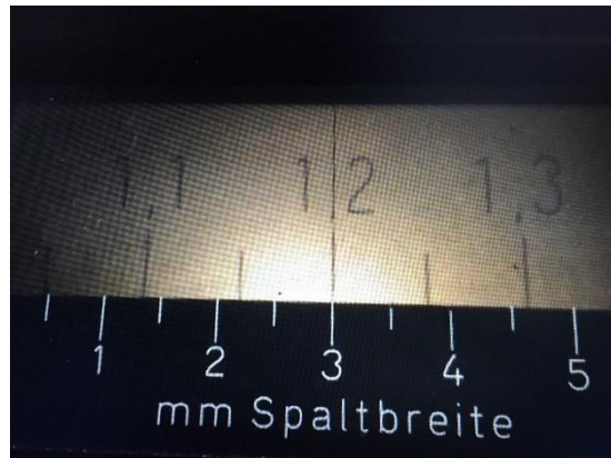
Rys. 4. Przykładowy odczyt wyniku ze skali monochromatora
